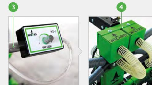
Le double dépresseur 12V est régulé par un seul contrôleur et les deux dépresseurs se connectent à un collecteur qui unifie le vide. L'avantage est que tant du point de vue de la gestion de la dépression que du point de vue du contrôle de la dépression, tout est unifié par un seul contrôleur et une seule jauge à vide, comme la série WZ-G.
