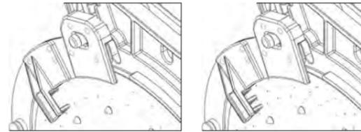
Un sélecteur pour la solution R2 avec 2 lignes d'ensemencement et un pour la solution R3 avec 3 lignes d'ensemencement. Simples à appliquer sans aucune utilisation d'outils, ils remplacent le sélecteur de semences à une rangée. Ils adhèrent parfaitement au disque et empêchent le passage de plus d'une graine par trou sans les endommager.
